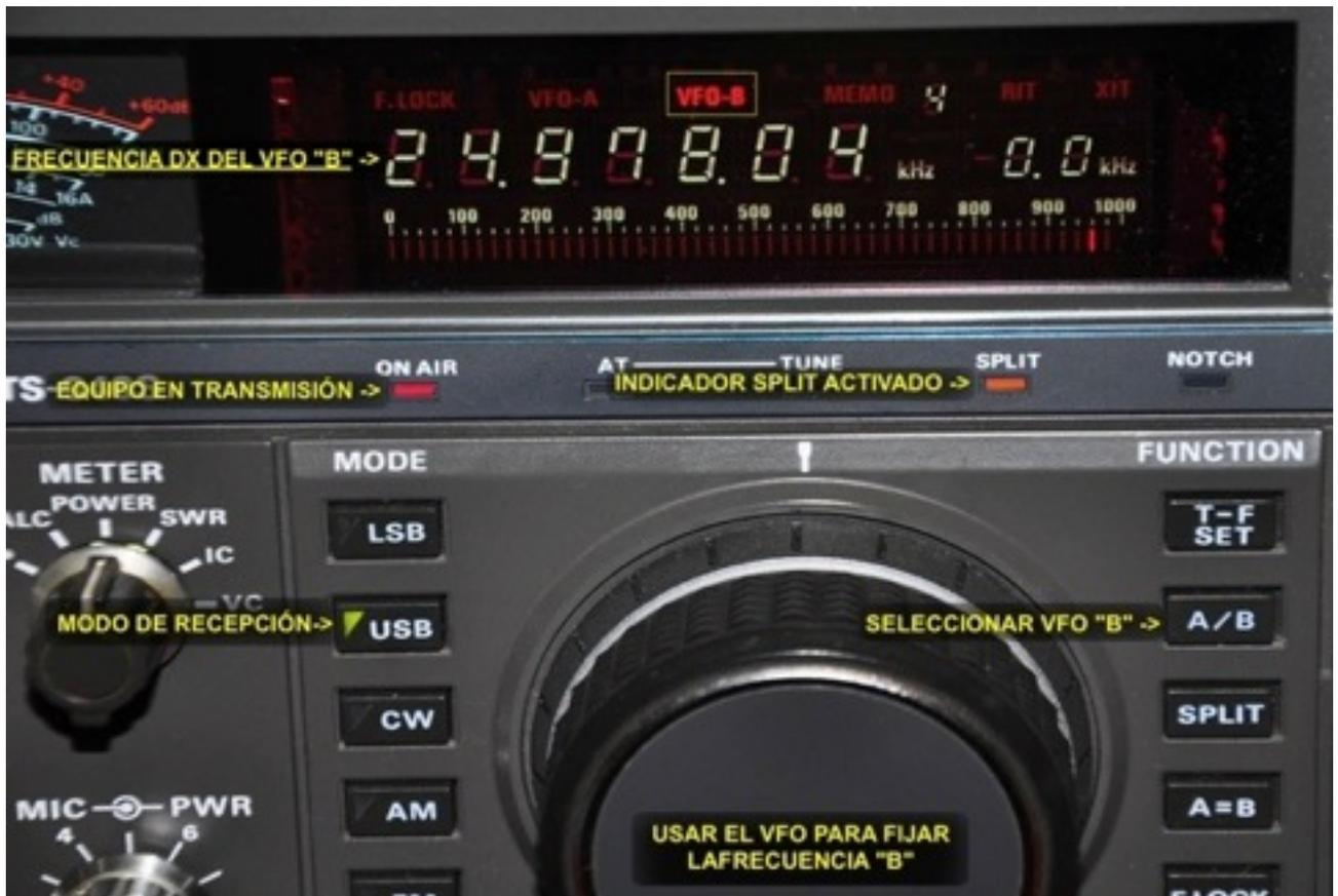
El montaje mas deseado es tener lo que se conoce como un “sub-receiver - sub-receptor”. Esto te da verdadera capacidad de transmitir en una frecuencia, recibir en esa misma frecuencia y al mismo tiempo, recibir en otra frecuencia. Hablaremos mas de las ventajas del sub-receptor en un minuto.
